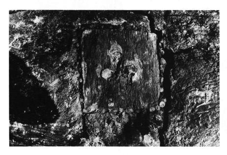
Fig. 14 Planche nº 3, rapiècement carré, vu depuis sous le fond, avec clous de fixation et calfatage. Longueur d'un côté: 17 cm.
