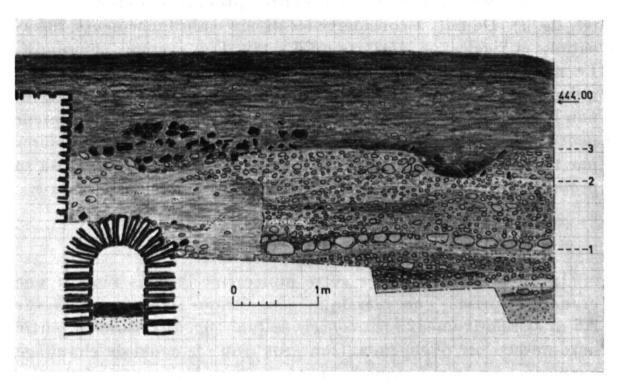
Fig. 7. — Section transversale d'une route romaine « En Perruet » (coupe 5, profil de la paroi sud). A gauche, le mur d'un grand bâtiment officiel, bordé d'un canal en moellons de calcaire jaune. Le lit de la route est formé de couches de gravier grossier mêlé de galets (respectivement remblai et couche inférieure), alternant avec des couches de gravier jaune (surface). Sur la couche supérieure de gravier, débris de briques provenant d'un bâtiment jouxtant.
