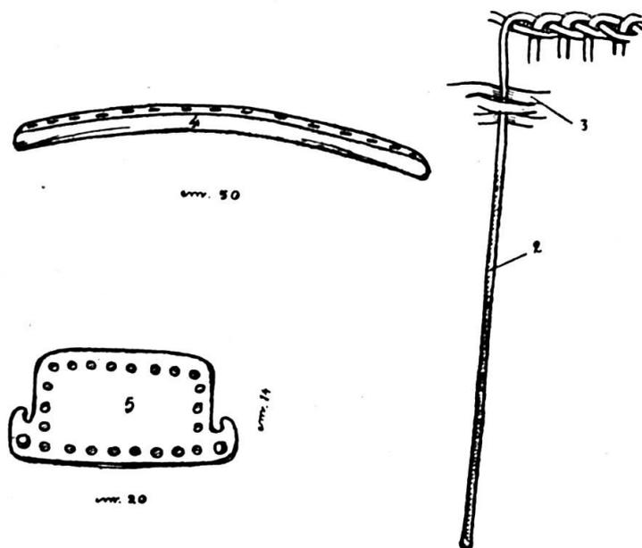
Fig. 147. — Parti del *gern*: 1. (v. sopra) *la pajrena*, il manico. 2. *i viman*, le stecche verticali. 3. *i skudesh*, le stecche orizzontali. 4. *el givvel*, il pezzo di legno ricurvo attraversato dalle stecche verticali. 5. *el pę*.
