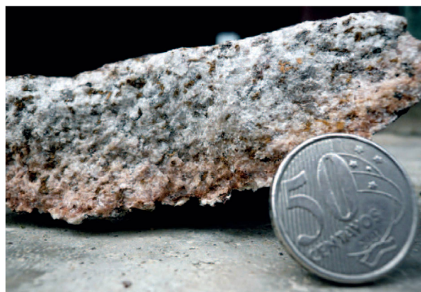
2.8. Estágio inicial de alteração de granito, caracterizado por zona de cor marrom-alaranjada, na parte externa de uma amostra-de-mão.
