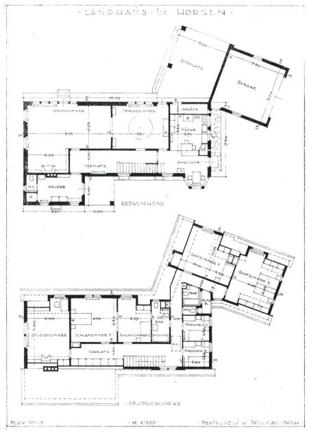
Abb. 49: Grundrisspläne Erdgeschoss und Obergeschoss für ein Landhaus in Horgen. (Privatbesitz)
