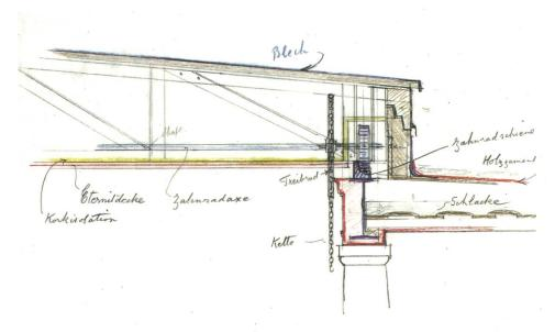
Hallenbad-Anbau, Konstruktionsskizze verschiebbares Dach, o.D., (Staatsarchiv Graubünden, Sign. XX 280 J).
