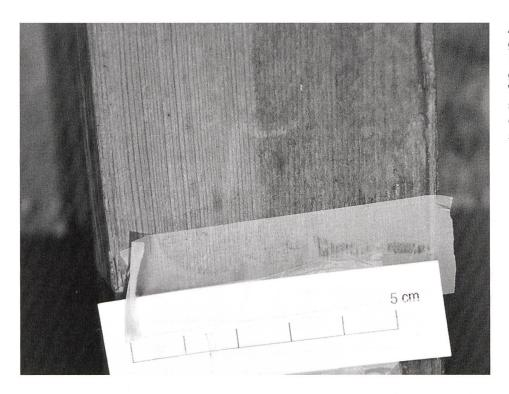
Abb. 10: Das dendrochronologisch untersuchte Holz No. 8 «Unterseite des Schienenträgers rechts». Rechts ist die Waldkante sichtbar, aus der sich für das Fällen der Lärche der Winter 1842/43 nachwei-
