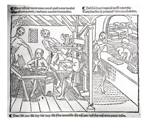
Abb. 7: Lyoner Totentanz (Ausschnitt; Matthias Huss, 1499) mit Setzerei und Druckerpresse aus Holz; rechts davon ist die Buchhandlung sichtbar. Die Druckerpresse ist nicht allzu wuchtig, aber in der Holzdecke verstrebt. Die Spindel läuft falsch, eventuell eine Folge der nicht bedachten Seitenverkehrung beim Druck des Holzstockes?
