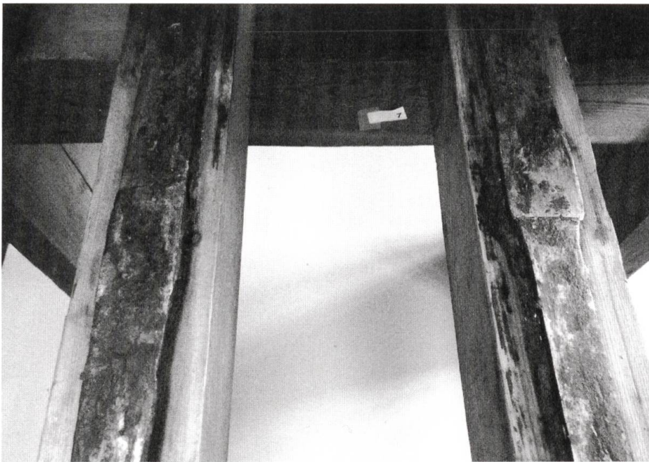
Abb. 4: Die angelängten Schienen, auf denen der Karren hinein- und herausgeburt wurde, sind (im Vergleich mit andern Pressen) sehr wenig abgenutzt. Ihre raue Oberfläche liess zudem den Bleisatz beim Hin- und Herfahren des Karrens erzittern, was leicht zu hochsteigenden Buchstabenabständen (sog. Spiessen) führen konnte, die dann plötzlich wie senkrechte Striche druckten.
