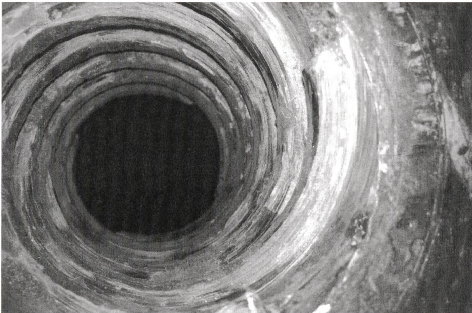
Abb. 5: Zur Vermassung der Spindel mittels Scan wurde diese aus der originalen Presse ausgebaut. Für kurze Zeit war ein Blick in das Innere der angegossenen Messingmutter möglich. Sie zeigt starke Abnutzungsspuren und dürfte mit der Spindel das älteste Stück der Presse sein. Wahrscheinlich wurde sie von einer abgegangenen Druckerpresse übernommen.
