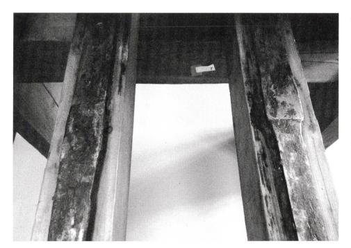
Abb. 4: Die angelängten Schienen, auf denen der Karren hinein- und herausgekurbelt wurde, sind (im Vergleich mit andern Pressen) sehr wenig abgenutzt. Ihre rauhe Oberfläche liess zudem den Bleisatz beim Hin- und Herfahren des Karrens erzittern, was leicht zu hochsteigenden Buchstabenabständen (sog. Spiessen) führen konnte, die dann plötzlich wie senkrechte Striche druckten.
