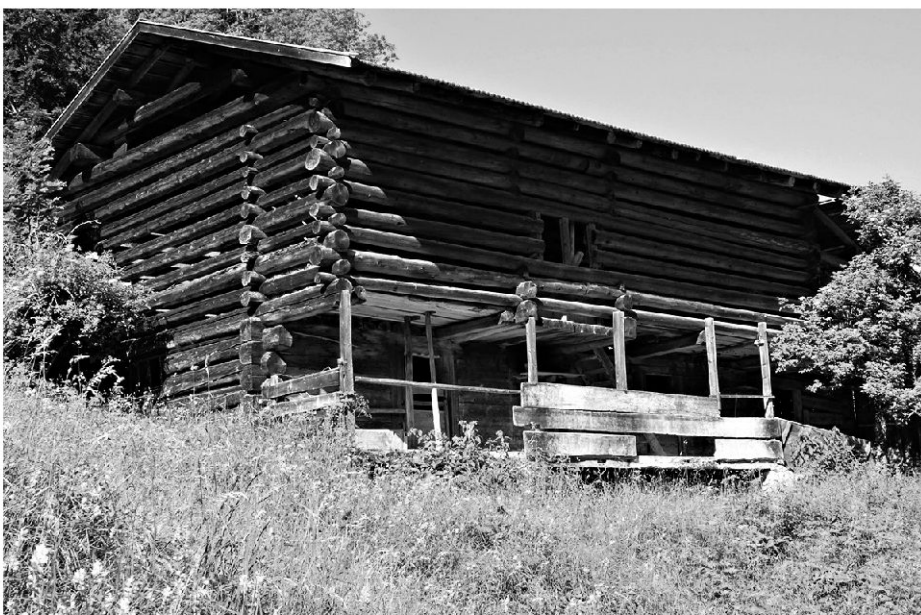
Stallscheune mit Kant- und Rundholzblock in Conters, Unter Cafrida. Auskragendes Obergeschoss mit Dreschtenne, 18./19. Jahrhundert (Foto: Benno Furrer, 2010).
