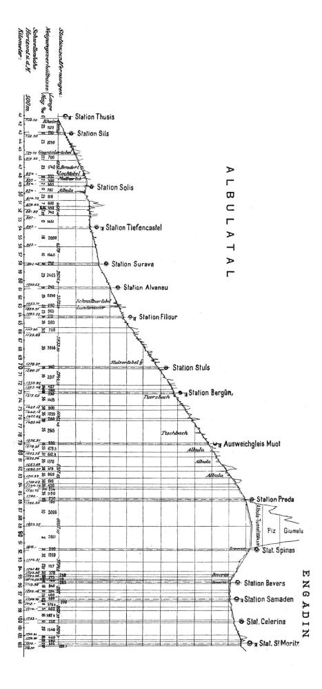
Streckenprofil der Albulalinie (verkleinerte Illustration aus: Enzyklopädie des Eisenbahnwesens. Hrsg. von [Victor] von Röll. Bd. 1. Berlin und Wien 1912).
