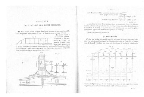
Die Berechnung eines Vierendeel-Trägers mit an den Enden nach unten geführten Obergurten ... (In: Arthur Vierendeel. Cours de Stabilité des Constructions. Bd. 4. Louvain, 1920, S. 212).
