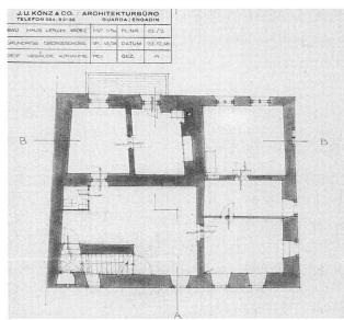
Oben links: Grundriss Erdgeschoss, 1969. Suler (piertan) mit Stube, Küche und Vorratskammer. Verkleinerter Aufnahmeplan.
