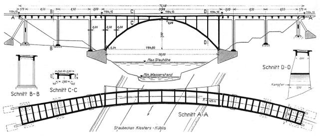
Landquartbrücke bei Dalvazza von Johann Solca 1930 (später abgebrochen). Im Längsschnitt offenbart diese Brücke ihr innovatives Hohlkastensystem, in der Ansicht jedoch blieb diese überraschende Neuigkeit ohne formale Folgen. (aus: M. Roš, Versuche an ausgeführten Eisenbeton-Bauwerken in der Schweiz, Eidgenössische Materialprüfungsund Versuchsanstalt für Industrie, Bauwesen und Gewerbe – Zürich, Bericht Nr. 99, 1937, S. 127.)
