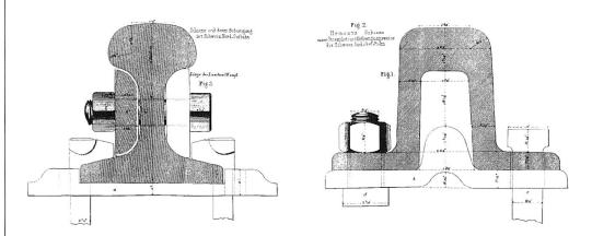
Beide Querschnitte sind an einem Schienenstoss gemacht. Die NOB-Schiene links wiegt 34 kg/m, diejenige der SOB rechts 32 kg/m, sie werden im Ankauf vergleichbar teuer gewesen sein. Die NOB-Schienen wurden durch 4-löchrige Laschen und Schraubenbolzen verbunden. Die Befestigung auf den Schwellen erfolgte durch Hakennägel und Unterlagsplatten: ein Oberbautyp, wie er 150 Jahre später auf Nebengleisen immer noch gefunden werden kann.
