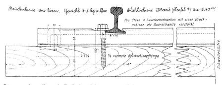
Stossschwelle mit Brückschiene verstärkt.
