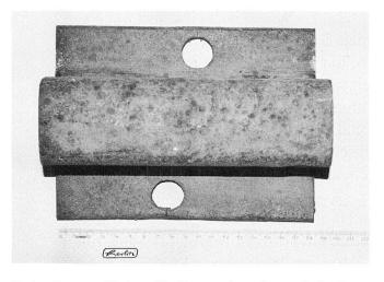
Befestigungslöcher für Querschwellen mit Anrissen.
