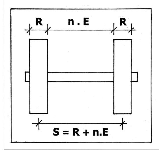
15 Schema zur Interpretation der Spurweite als Multiple einer Masseinheit (E=Palm=1/4 Fuss=7.4 cm). Bisher sind Realisierungen mit 9 verschiedenen Zahlenwerten n bekannt. Die **Uebereinstimmung** zwischen gemessenen und mit dem antiken Fussmass berechneten Werten kann als Hinweis zur Zeitstellung dienen.
