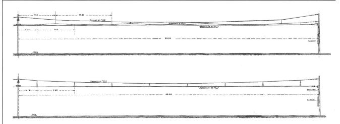
burger Bauweise etwas überarbeitet zu haben. Die Ausführung mit Hilfsdraht wurde, etwas vereinfacht, für die Abschnitte oberhalb Bever (11 km) vorgesehen. Für die Strecke Bever–Scuol (64 km) verwendete man eine Ausführung nur mit Tragseil und Fahrdraht im Sinne eines Versuches (beide in Bild 4).
