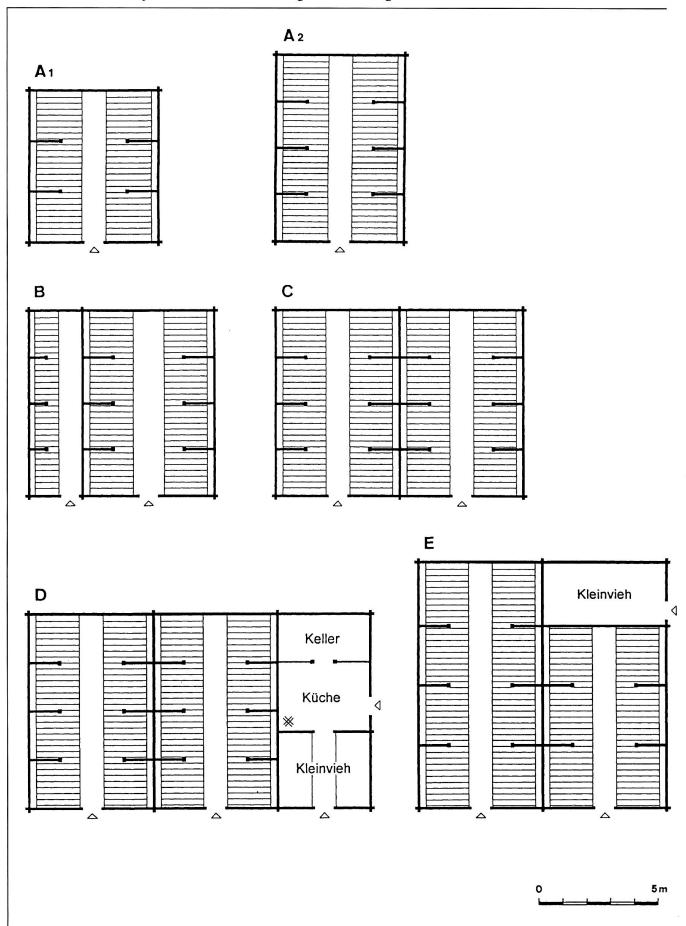
Abb. 9: Grundrissvarianten der Stallräume.
