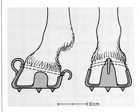
Abb. 8: Eiserner Hufschuh am Pferdefuss: Front- und Seitenansicht.<sup>68</sup>
