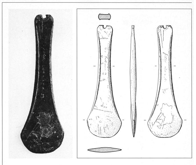
des Beiles. Der Nacken des Beiles ist stark gestaucht und die Patina im Nackenbereich beschädigt. Und auch die Schneidepartie weist mehrere Beschädigungen und an einer Stelle gar eine Art «Brauenbildung» auf. Es macht durchaus den Anschein, dass dieses Objekt nachträglich als «Gebrauchsgerät», d. h. z. B. als Keil, Meissel oder dergleichen sekundär verwendet wurde. Auch Schlag- und Kratzspuren im Schneidebereich weisen durchaus auf eine Verwendung des Objektes in jüngerer Zeit hin.
