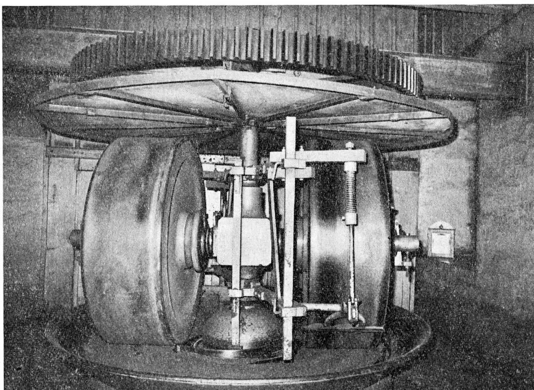
Gegenwärtig sind in der alten Pulvermühle noch drei vom Mühlbach angetriebene Mühlen in Betrieb. Auf unserem Bild werden 50 kg Pulver bearbeitet, und zwar während 90 Minuten, was etwa 900 Umdrehungen der mannsgrossen Mühlsteine entspricht. Danach kommt das Schwarzpulver in ein Nebenhäuschen, wo es gekörnt wird, um dann während 48 Stunden getrocknet zu werden. Nachdem es noch fein poliert worden ist, wird es fertig verpackt. Am Tag werden so etwa 600 kg Schwarzpulver hergestellt.
