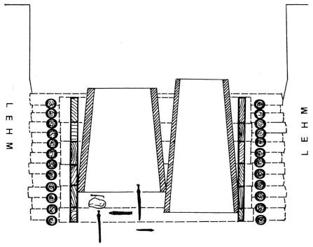
Abb. 3. Schnitt durch die Quellfassung
