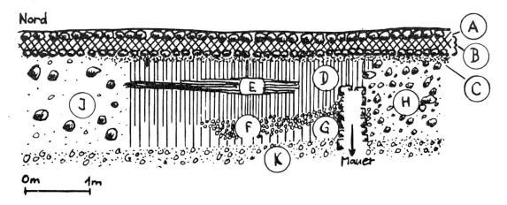
Abb. 2. Chur/Liegenschaft Schneller. Schichtenprofil der Südhälfte der östlichen Sondiergrabenwand. Schichten: A Kellerboden mit Steinbett / B Mörtelboden mit Steinbett / C sandig-kiesiger Lehm / D Schmutz, Sand, Kies / E Lehm / F Kies, Sand, Kalkspuren / G Schmutz, Kies / H Sand, Kies, Bollen / J grober Kies, Bollen / K anstehender Schotter.
