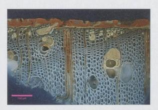
Abb. 21: Lichtmikroskopische Untersuchung durch Balthazar Soulier, 2010: Laute von Hans Frei, ca. 1540, KHM Wien, Inv. SAM 29, originaler Lack auf Lautenspan. Foto: B. Soulier
