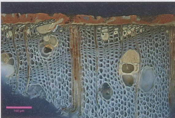
Abb. 21: Lichtmikroskopische Untersuchung durch Balthazar Soulier, 2010: Laute von Hans Frei, ca. 1540, KHM Wien, Inv. SAM 29, originaler Lack auf Lautenspan. Foto: B. Soulier
