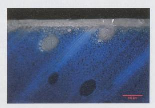
Abb: 22: Lichtmikroskopische Untersuchung durch Balthazar Soulier 2013: Firnis für Renaissance-Viola da gamba mit dem von Simon Glaus (Geigenbauschule Brienz) hergestellten Lack auf Ahornholz, Foto: B. Soulier
