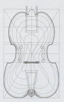
Abb. 18: Plan der Viola da gamba nach Ganassi mit asymmetrische Deckenstärken. Zeichnung: T. Hirsch
