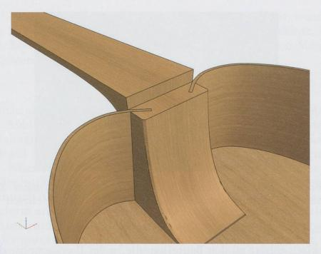
Abb. 20: Viola da gamba nach Ganassi, 3D-Modell. Durchgesetzter Hals mit eingesägten Schlitzen. Zeichnung: T. Hirsch, 3D-Modell: René Racz
