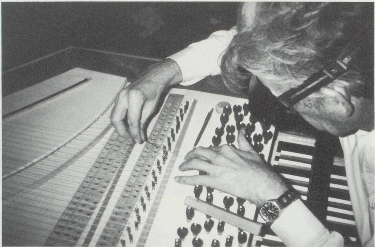
Abb. 5: Einfeilen „subtiler Kerben“ zum Einlegen der Saiten. Rechts der kombinierte Stimmstock mit Lautenwirbeln.
