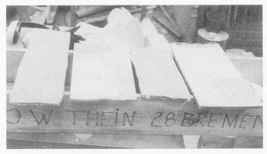
Abb. 14: Messingbarren, die in einer plattenartigen Kokille gegossen wurden. Maße: 330 x 210 x 12 mm. Diese Kokillengröße erwies sich als sehr günstig für das Blechschmieden, während z. B. für die Saitenherstellung eher strangartige Kokillen angezeigt sind.
