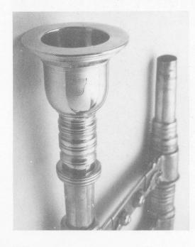
Abb. 24 (oben): Auf dem Bild sind die Außenzugrohre zu sehen. Zwischen den Messinghülsen rechts im Bild ist schon der Platz für das zukünftige Scharnier erkennbar.
