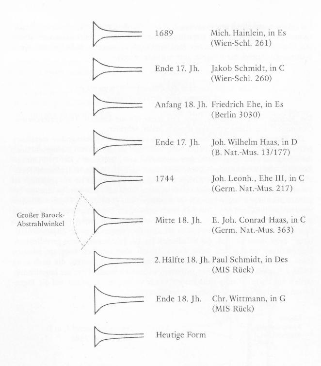
Ein Vergleich der Mensuren möglichst vieler verschiedener Renaissance- und Barockinstrumente würde die Unterschiede weiter verdeutlichen.<sup>23</sup> Hier folgt eine Aufstellung von Abmessungen solcher Instrumente, die ich vermessen habe. Als Tendenz läßt sich daraus entnehmen: In der Renaissance finden wir bei großem Luftdurchgang im Zug (Mensur) einen relativ kleinen Schallbecherdurchmesser. Im Barock ist die Mensur viel kleiner, der Schallbecher aber größer im Durchmesser.
