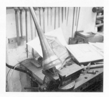
Abb. 23: Der Schallstückkonus ist im Schraubstock eingespannt. Der Kranz ist dem Ende des Konusses angepaßt.
