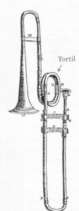
Abb. 11: Tortil (nach Marin Mersenne), ein Krummbügel, der zwischen Schallstück und Zug gesteckt wird und die Posaune um eine Quarte tiefer stimmt.<sup>20</sup>
