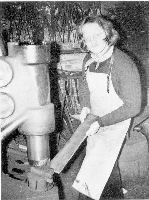
Abb. 16: Der Autor an einem Hammerwerk in Gerstheim im Elsass. Durch komprimierte Luft wird der obere Hammerkolben auf den unteren Amboß geschleudert.
