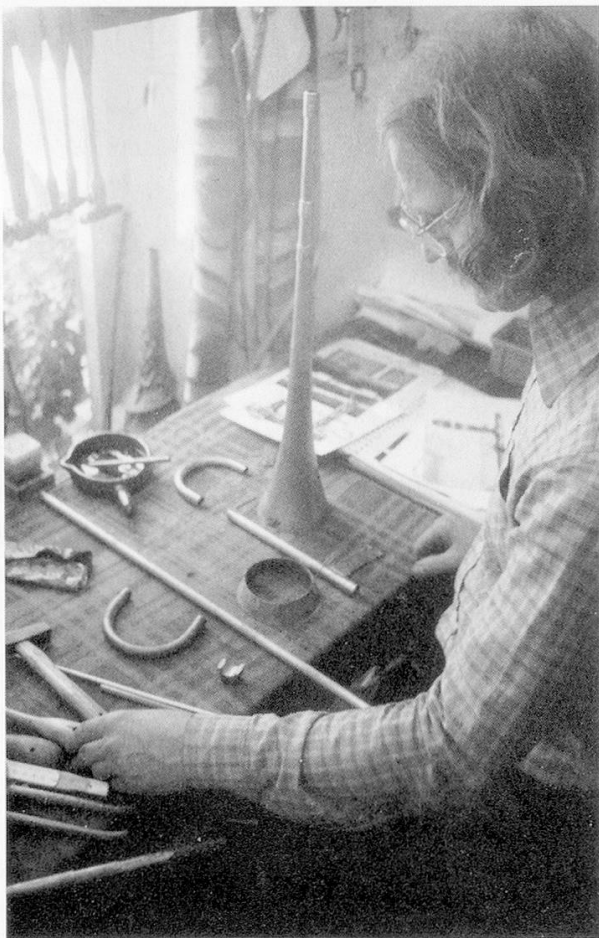
Abb. 21 und 22: Die Posaune nimmt langsam Gestalt an. Auf dem Werk Tisch (rechts) liegt der fertig ausgehämmerte Schallbecher mit aufgestecktem Bogen und Seitenteil, daneben der Blechring für den Kranz, ein fertiges Zugrohr und der Zugbogen.
