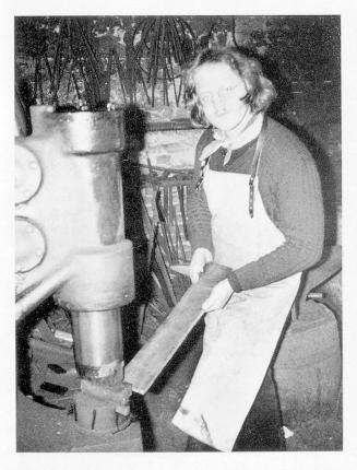
Abb. 16: Der Autor an einem Hammerwerk in Gerstheim im Elsass. Durch komprimierte Luft wird der obere Hammerkolben auf den unteren Amboß geschleudert.
