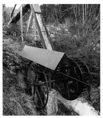
Das Wasserrad am Siater Bach ist über ein 156 m langes Drahtseil mit der Werkstatt verbunden. (Foto Silvia Conzett 2012)
