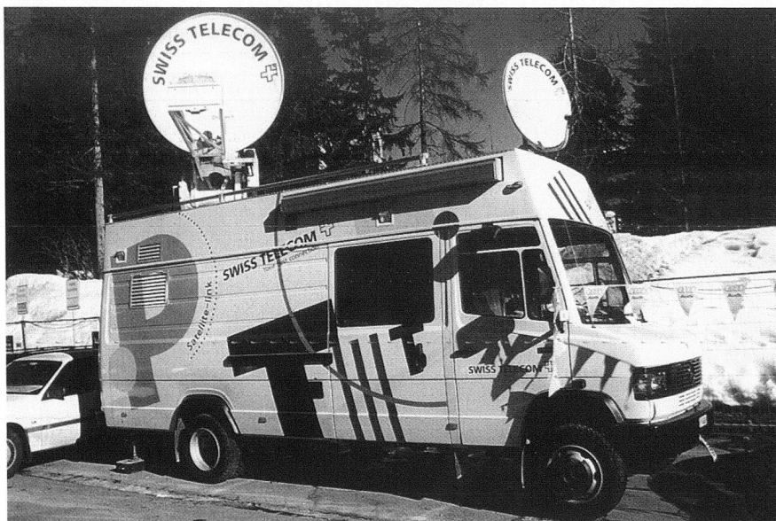
«Media Link», der Satellitendienst der Swisscom, bietet innert kürzester Zeit leistungsfähige Satellitenverbindungen für die Übertragung von Fernsehreportagen und grossen Datenmengen in alle Welt. (Aufnahme: Marco Crameri, Swisscom Chur).
