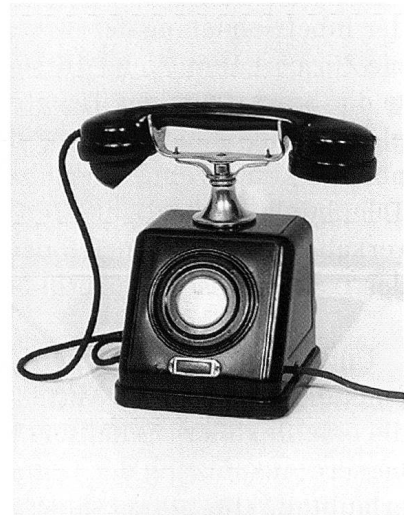
Apparate für Lokalbatterie-, Zentralbatterie- und automatischen Betrieb: links die Lokalbatterie-Tischstation von Bell Antwerpen, importiert zwischen 1893 und 1900. Als LB-Station erkennbar an Kurbel und Batteriekasten. In der Mitte eine Zentralbatterie-Tischstation von Zwietsch, von der Hasler AG in der Schweiz in Lizenz gebaut ab 1917. Das Gehäuse ist kleiner, weil es keine Batterie enthält, und es fehlt die Kurbel. Rechts eine ZB-Tischstation von Siemens & Halske, vorbereitet für den automatischen Betrieb, gebaut um 1920. Bei Automatisierung eines Netzes konnte die runde Scheibe herausgebrochen und eine Wählscheibe mit Nummernschalter eingesetzt werden. So blieb der Apparat weiter verwendbar. (Fotos: PTT-Museum Bern).
