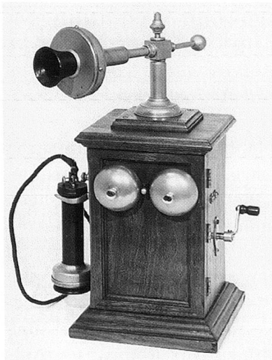
Apparate für Lokalbatterie-, Zentralbatterie- und automatischen Betrieb: links die Lokalbatterie-Tischstation von Bell Antwerpen, importiert zwischen 1893 und 1900. Als LB-Station erkennbar an Kurbel und Batteriekasten. In der Mitte eine Zentralbatterie-Tischstation von Zwietsch, von der Hasler AG in der Schweiz in Lizenz gebaut ab 1917. Das Gehäuse ist kleiner, weil es keine Batterie enthält, und es fehlt die Kurbel. Rechts eine ZB-Tischstation von Siemens & Halske, vorbereitet für den automatischen Betrieb, gebaut um 1920. Bei Automatisierung eines Netzes konnte die runde Scheibe herausgebrochen und eine Wählscheibe mit Nummernschalter eingesetzt werden. So blieb der Apparat weiter verwendbar. (Fotos: PTT-Museum Bern).
