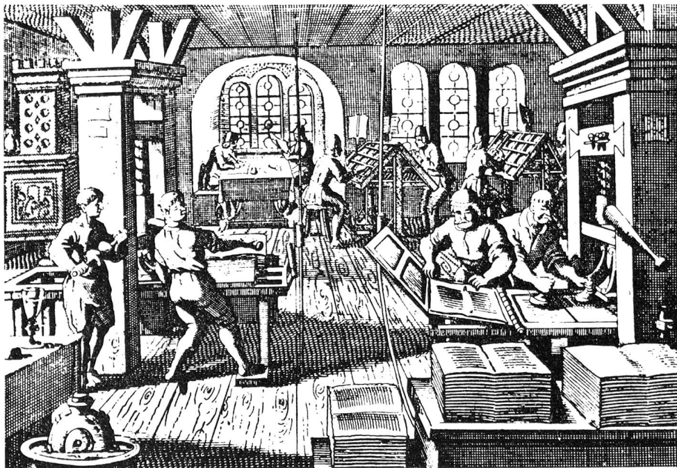
Buchdruckerwerkstätte aus dem 17. Jahrhundert. Der Preßmeister an der rechten Druckpresse ist gerade dabei, ein eben bedrucktes Blatt vom «Deckel» abzuheben, während der «Ballenmeister» die beiden Druckformen neu einfärbt. (Bild aus der Zeitschrift «Papier und Wir» der Papierfabrik Albert Ziegler A.-G., Grellingen.)
