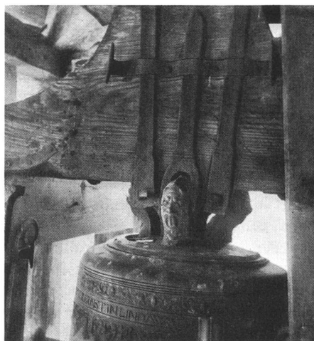
Dieselbe Glocke mit dem Gußfehler zwischen Krone und Hals
