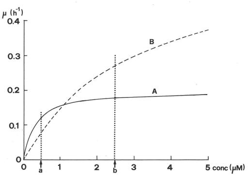
Fig. 1. Relation (selon le modèle de J. Monod) entre le taux de croissance et la concentration du substrat limitant. Simulation pour les paramètres suivants:
