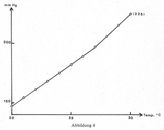
Temperaturabhängigkeit der Messung mit der Mikrosauerstoffelektrode
