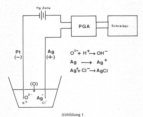
Prinzip der Messung und Elektrodenreaktionen
