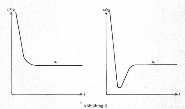
Einfluss der Polyphenoloxydasenreaktion auf die Messung (schematisch). a = keine Reaktion, b = starke Reaktion
