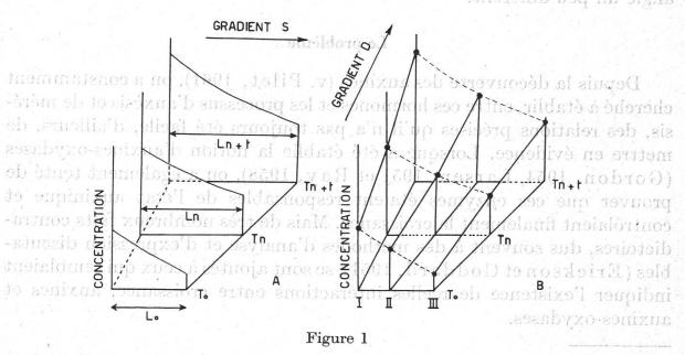
Gradients statique (A: Gradient S) et dynamique (B: Gradient D) pour diverses longueurs de racines ( $L_o$ ,  $L_n$  et  $L_{n+t}$ ) et à des temps différents ( $T_o$ ,  $T_n$  et  $T_{n+t}$ )
