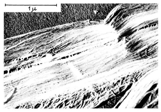
Abbildung 3 Elektronenbild der Sekundärwand von Baumwolle 1948 (21). Rechts eine Verschiebungsfigur (vgl. Textfiguren 4 und 5)
