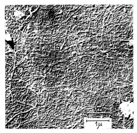
Abbildung 5 Elektronenbild der Primärwand einer Flachsfaser 1948 (21)
