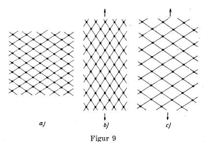
Schema des Flächenwachstums primärer Zellwände 1936 (6). a Röhrentextur; b Umorientierung der Stränge bei künstlicher Dehnung; c Maschenausweitung beim Flächenwachstum
