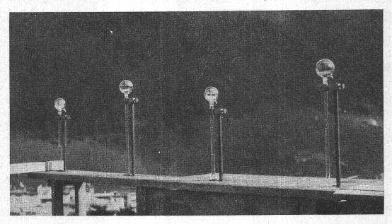
Abbildung 2. Aufstellung der Kugelpyranometer auf dem Dach des Obervatoriums in Davos.
