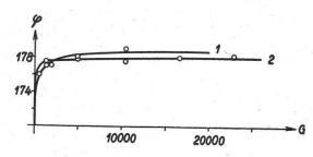
Fig. 28. Auslöschwinkel  $\varphi$  für 5%ige Pinuswachslösungen in CCl<sub>4</sub> bei  $\eta_{\rm t}=195$  und Untersuchungstemperatur 20° (Kurve 1);  $\eta_{\rm t}=175,\!6$  und Temperatur 27° (Kurve 2).
