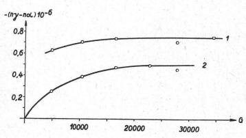
Fig. 17.  $n\gamma-n\alpha \text{ von verschieden konzentrierten Karnaubawachsschüppchenlösungen in CCl<sub>4</sub>. 1:1% ige Lösung bei 25° und <math>\eta_t=109.8$ . 2:5% ige Lösung bei 35° und  $\eta_t=126.6$ .
