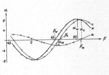
In Fig. 29 ist ebenfalls der Verlauf der entsprechenden Sinuskurve für das Lösungsmittel m-Kresol (m) eingetragen. Wie man sieht, sind die Kurven s und m um zirka  $\pi/4$  gegeneinander verschoben. Wenn
