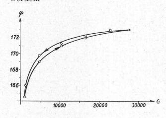
Fig. 14. Hysteresisähnliche Kurve für die Auslöschwinkel  $\varphi$  einer 1%igen Karnaubawachslösung in Toluol bei 29° und  $\eta_{\rm t}=63.8$ .
