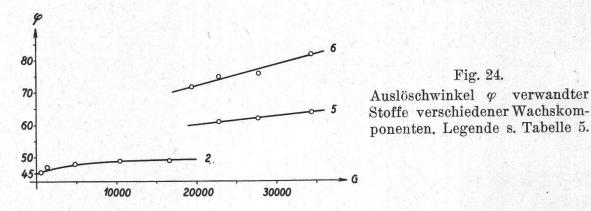
Alle Auslöschwinkel liegen entsprechend der positiven Strömungsdoppelbrechung zwischen 45° und 90°. Wie aus Tabelle 5 hervorgeht, waren sie nicht für alle untersuchten Stoffe genau bestimmbar. Die besten Resultate sind in Fig. 24 zusammengestellt. Die Frage bleibe dahingestellt, warum z. B. Amylalkohol so unerwartet hohe Auslöschwinkel liefert.
