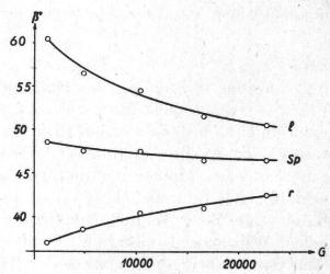
Fig. 5 zeigt, dass auch Abweichungen von diesem 48°-Mittelwert möglich sind. Die Auslöschwinkel  $\beta'$  sind für eine 5% ige Pinuswachslösung in CCl<sub>4</sub> aufgenommen. Das Absinken der Mittelwerte ist wahrscheinlich bei dieser Lösung zur Hauptsache darauf zurückzuführen, dass während der Messung Micellbildung stattgefunden hat (vgl. Ab-
