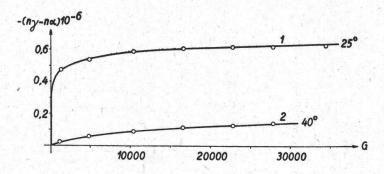
Fig. 9.  $n\gamma - n\alpha$  einer 1% igen Karnaubawachslösung in CCl<sub>4</sub> bei verschiedenen Temperaturen.  $\eta_t$  25° = 112,8;  $\eta_t$  40° = 94,2.
