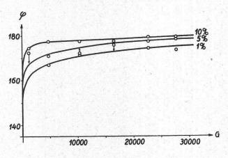
Fig. 8. Auslöschwinkel  $\varphi$  von verschieden konzentrierten Karnaubawachslösungen in CCl<sub>4</sub> bei 40°. Legende wie bei Fig. 7.
