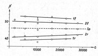
Fig. 4. Auslöschwinkel  $\beta'$  von Wachslösungen bei Links- und Rechtsrotation. 1 l= Auslöschwinkel bei Links-, 1 r bei Rechtsrotation einer 5% igen Karnaubawachslösung in CCl<sub>4</sub> bei 35° und  $\eta_t=126,6$ . 2 l und 2 r sind die entsprechenden Winkel einer 5% igen Pinuswachslösung in CCl<sub>4</sub> bei 27° und  $\eta_t=175,6$ . Sp= Spaltachse
