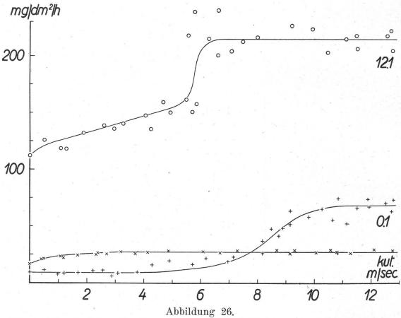
Quercus Ilex L. (Versuchspflanze Nr. 68). Die Wasserabgabe je dm² Blattfläche bei steigender Windgeschwindigkeit.
