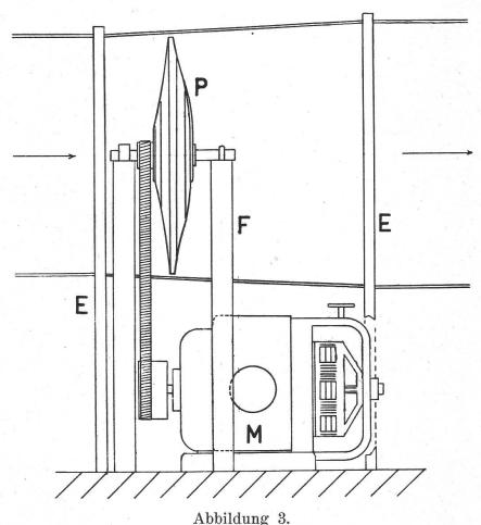
Längsschnitt durch das Gebläse. 1:20. Erklärung im Text.
