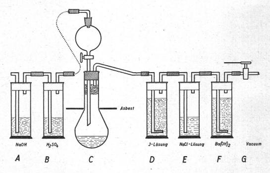
Schwefelsäure gefüllt ist. Die vorgelegte Schwefelsäure dient zur Absorption des aus der NaOH-Lösung mitgerissenen Wasserdampfes. Als zweckmässig erwies sich ein lose im Kolbenhals (C) sitzender Glaswollebausch, der das Kondenswasser in feinen Tröpfchen zurückhält und verhindert, dass dasselbe in grösseren Tropfen in die heisse konzentrierte Schwefelsäure zurückfällt. Aus diesem Grunde ist auch die Schrägstellung des Verbrennungskolbens C empfehlenswert.
