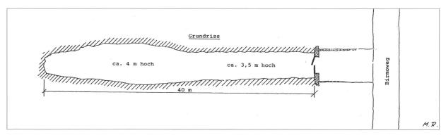
152 Hinter dem Eingangstor erstreckt sich der ausgebrochene Teil 40 m weit. Die Höhle ist 4 – 5 m breit und 3,5 – 4 m hoch. Das entspricht eigentlich nicht dem Plan, denn dieser sah ein solches Profil erst im Bereich der Liegestellen vor.
