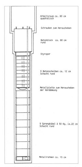
182 Vermuteter Aufbau eines Sprengschachtes nach Beobachtungen bei Abbrucharbeiten des Militärs.
