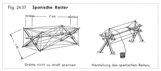
21 Das Reglement «Geniedienst aller Waffen» gibt genaue Anleitung über Grösse, Materialbedarf, Arbeitsvorgang und Zeitbedarf für Anlagen aller Art, hier für den «Spanischen Reiter». Solche lagen überall bei Durchlässen im Drahtverhau bereit; sie ermöglichten das rasche Schliessen der Lücken.
