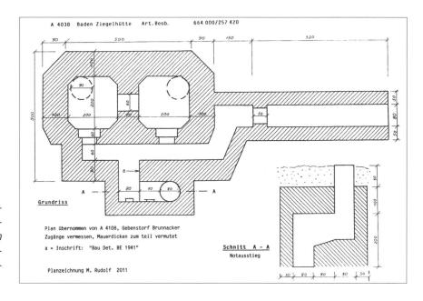
137 Plan des Doppelbeobachterstandes an der Kehlstrasse, ursprünglich durch den Schacht, 1941 durch einen horizontalen Gang erreichbar.
