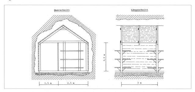
153 Es war geplant, in den ausgeweiteten Stollen als Inneneinrichtung Holzbaracken in Elementbauweise einzubauen. Bei trockenem und solidem Gestein war das eine Arbeit, die ganz gut ebenfalls durch die Sanitätssoldaten hätte verrichtet werden können. 1,5 m waren für den durchlaufenden Gang reserviert, 2,5 m blieben für die seitlichen Abteile mit den Liegestellen.
