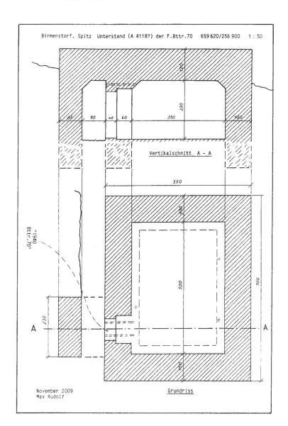
109 Plan des einstöckigen Unterstandes am Hinterhang. Er war durch einen gedeckten Laufgraben mit den 50 Meter weiter vorn liegenden Geschützstellungen verbunden.
