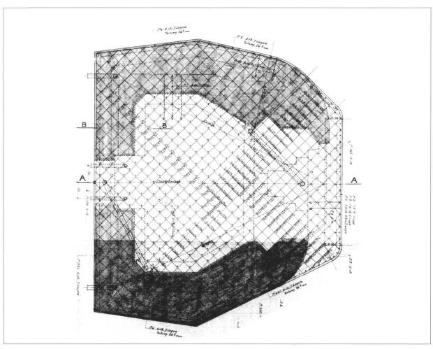
55 Detail zur Deckenarmierung: Das hier aufgezeichnete Netz verzeichnet die Längen der 18 mm dicken Eisenstangen, die bei den Sappeuren in Dättwil bestellt und dann herbeigeführt werden mussten. Für die 1,70 m dicke Decke brauchte es übereinander sieben solche Lagen im Abstand von 26,5 cm.
