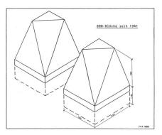
169 Schema eines BBB-Blocks: 7,7 m³, 20 Tonnen.
