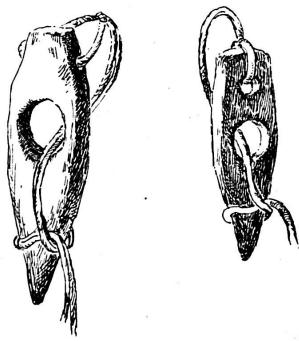
bois dur allongé, évidé au centre et terminé en pointe à une de ses extrémités, tandis que l'autre est percée d'un trou par où passe la corde dont la «trueille» n'est que l'accessoire. Le fonctionnement du système est aussi simple que pratique. Pour opérer le serrage, le bout libre de la corde qui entoure la charge est passé dans l'évidement de la «trueille», et l'arrêtage s'obtient en faisant seulement une boucle autour de l'extrémité amincie, comme le montre notre croquis.
