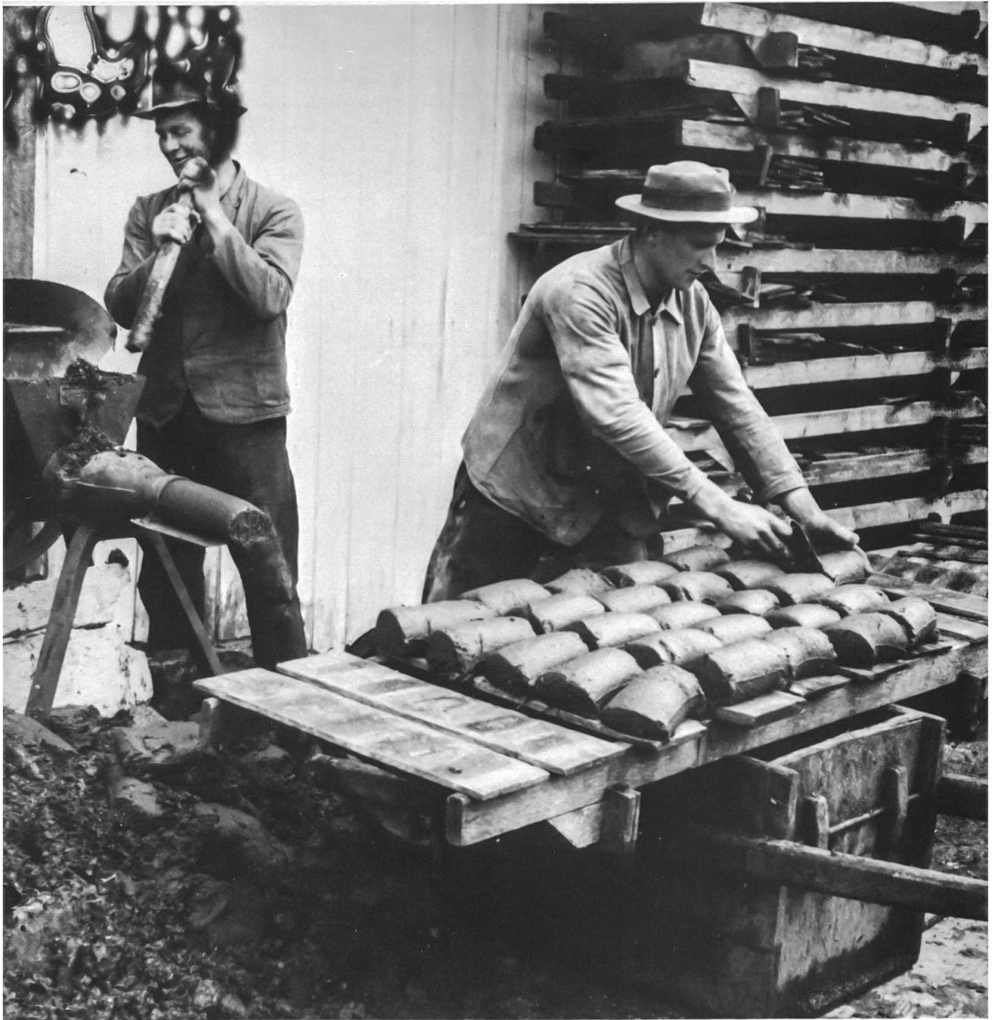
92 Nach dem Brennen im Frühling wurde der Trester in eine Kiste fest eingestampft, dann wurden mit einem Hohlstöpsel zylindrische Stücke herausgestochen, die sogenannten Träststöckli. Bei der mechanischen Herstellungsweise wurde, wie abgebildet, der Trester mit einer Hackmaschine zu Würsten gepresst, die geschnitten wurden und so ebenfalls zylindrische Stöckli ergaben. Die Träststöckli wurden nach dem Formen auf Gestellen zum Trocknen aufgeschichtet und im nächsten Winter in Zimmeröfen verbrannt. Häufiger war, dass man im nächsten Jahr damit die Schnapsbrennerei wieder anheizte. Das Bild zeigt die Herstellung von Träststöckli auf dem Ennerberg im Frühling 1939. Links Josef Barmettler, rechts Alois Barmettler.
