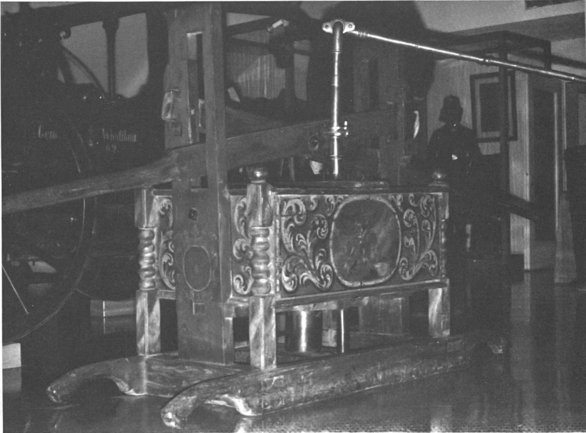
12. Schmucke Schlagspritze aus dem Jahre 1707. Der Kolben wird mit zwei Druckstangen auf- und abwärts bewegt, das Wasser mit dem «Schwanenhals» (Wenderohr) auf das Feuer gelenkt. Die eine Schmalseite trägt den Spruch: «Man brucht Mich in der Noth / Dar Vor behüet Euch Gott 1707.» — Die Spritze stammt aus Ossigen, Kt. Zürich. Städtische Brandwache Zürich.
