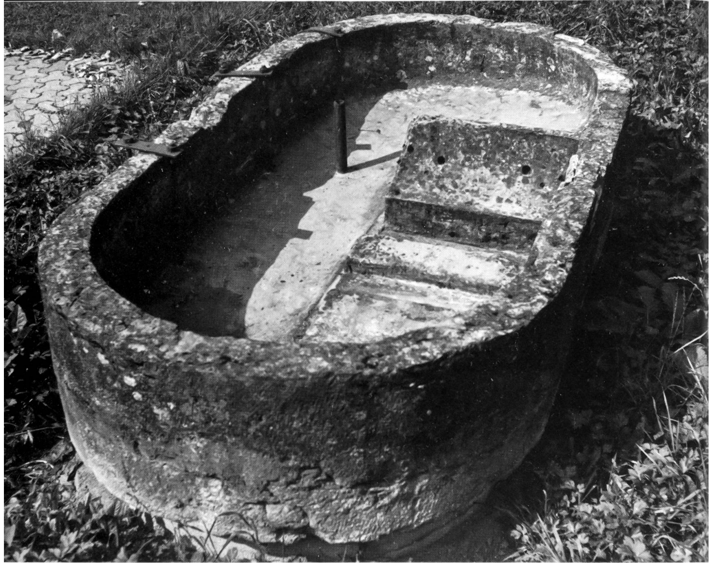
Holländer aus einem Kalksteinblock gehauen. Standort: Rotzloch. Länge 300, Breite 160, Höhe 60 cm.
