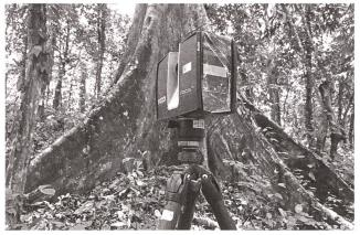
Abb. 1: Laser Scanning im Rahmen von SUSTAINFORESTS mit dem FARO M70 Terrestrial Laser Scanner (TLS) in einem Regenwald mit Lianen und invasiven Spezies. (Bildnachweis: Chinwe Ifeiika Speranza / Samuel Hepner)
