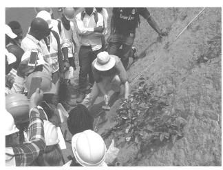
Abb. 2: Probennahme für die Lumineszenzdatierung in tropischen Böden zur Bestimmung von Erosions- und Umlagerungsphasen während des Quartärs demonstriert für Kooperationspartner der Universität Yaounde, Kamerun.
