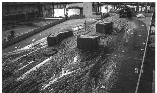
Abb. 6: Modellierung des Schnannerbachs bei Schnann im Institut für Wasserbau der Universität Innsbruck. (Foto: Chantal Schmidt)
