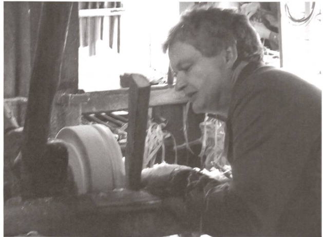
Abb. 3: Drehen von Holzreifen für Spielzeugtiere, Seiffen
