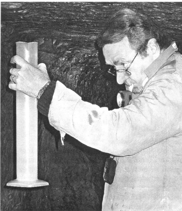
Auch heute noch sind präzise Handmessungen unverzichtbar, etwa zum Kalibrieren von automatischen Stationen
